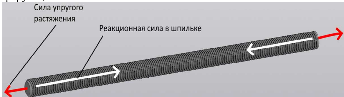
Рис. 2. Схема действия сил в шпильке
