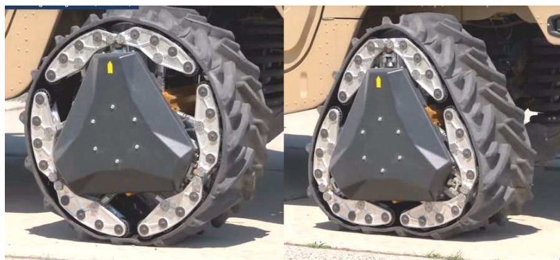
Рис. 2. Адаптивный движитель с изменяемой формой колеса
