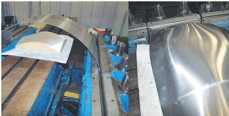
Рис. 2. Обтяжной пуансон, изготовленный методом FDM-печати; фото: ddmlab.ru
