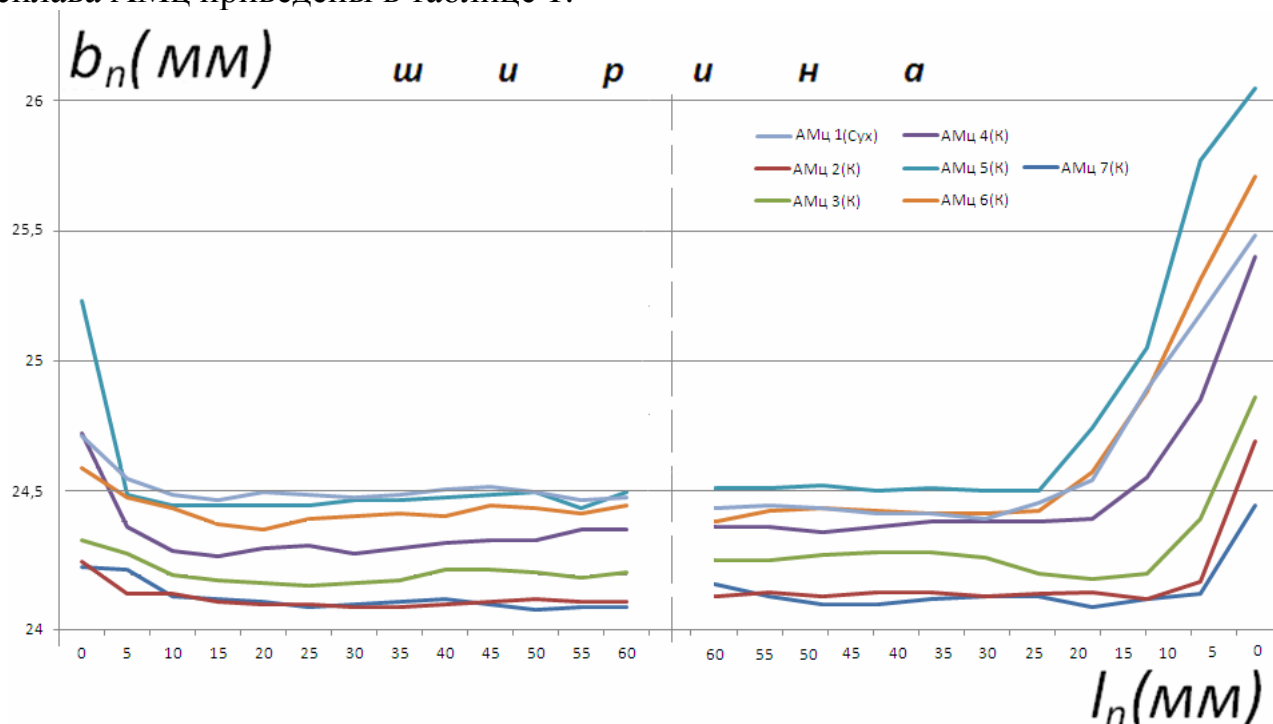
Рис. 2. Изменения ширины полосы алюминиевого сплава АМц на неустановившихся участках по её длине
