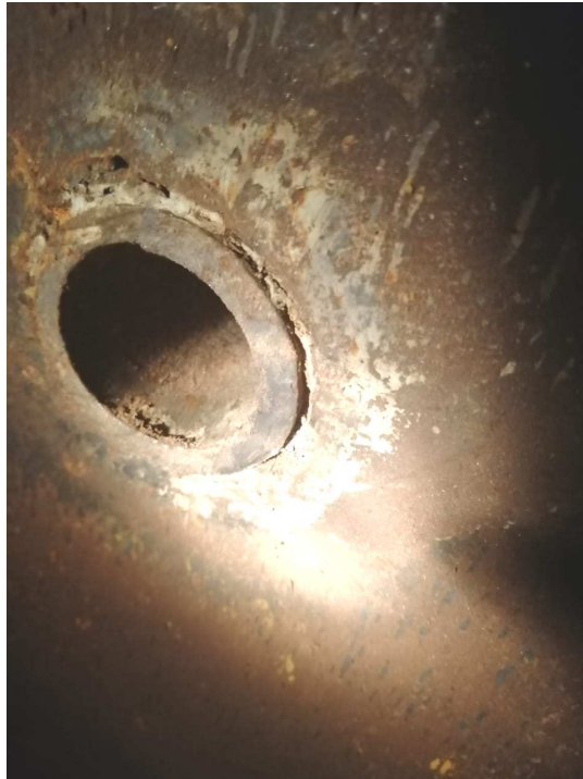
Рис. 3. Дефекты, обнаруженные в резервуаре, работающем под избыточным давлением и предназначенном для хранения сжиженных углеводородных газов: а) поверхностная (равномерная) коррозия; б) язвенная коррозия; в) неполное проплавление корня сварного шва
