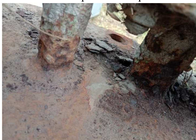
Рис. 4. РГ не прошла контроль по результатам УТ
