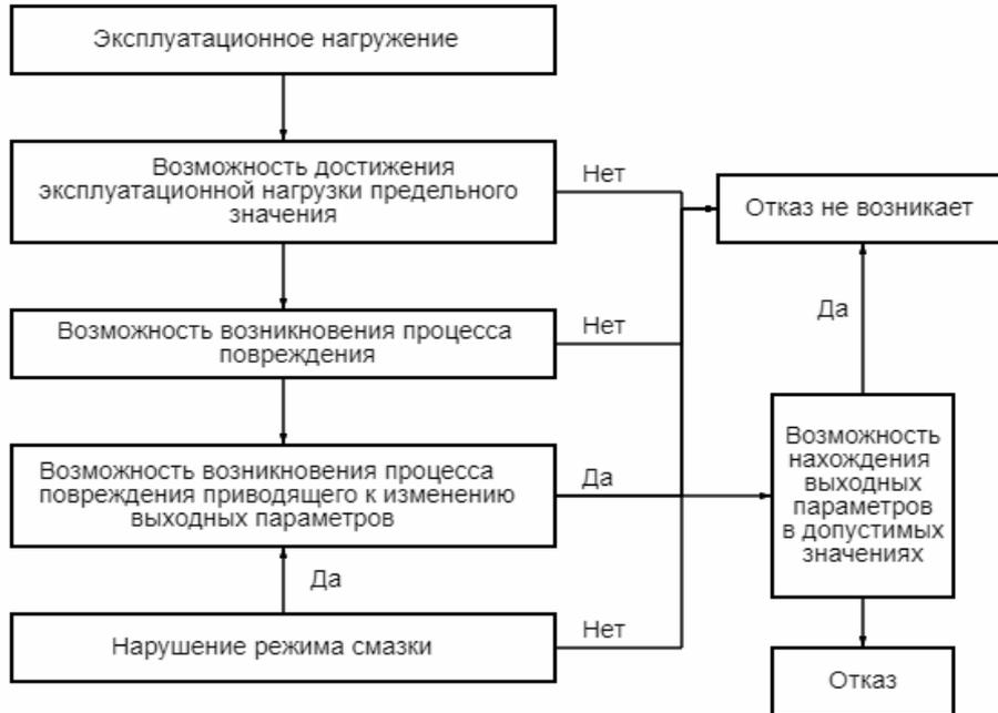
Рис. 1. Блок-схема возникновения отказа элементов шарнирно-рычажного механизма тормозного устройства подъемно-транспортных машин
