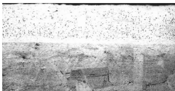
Покрытие – CoCrAlY (СДП-11) Основа – сплав ЭИ-893
