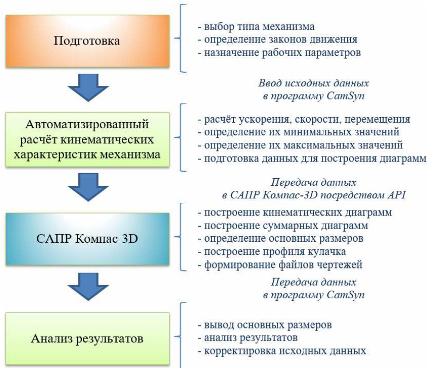
Рис. 1. Укрупненный алгоритм работы программы CamSyn
