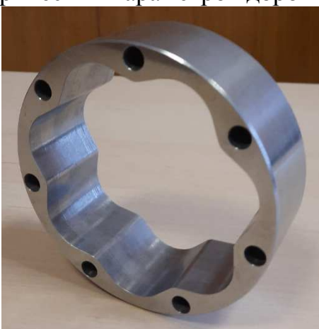
Рис. 1. Деталь с многопериодной дорожкой: а – фотография; б – схема геометрических параметров дорожки
